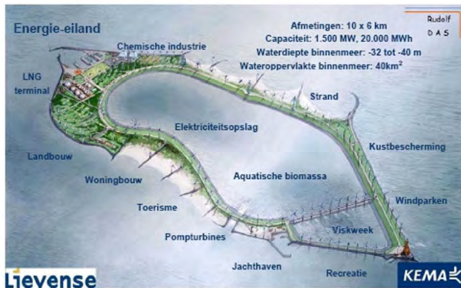
Figuur 1 Schets van het Energie-eiland.
